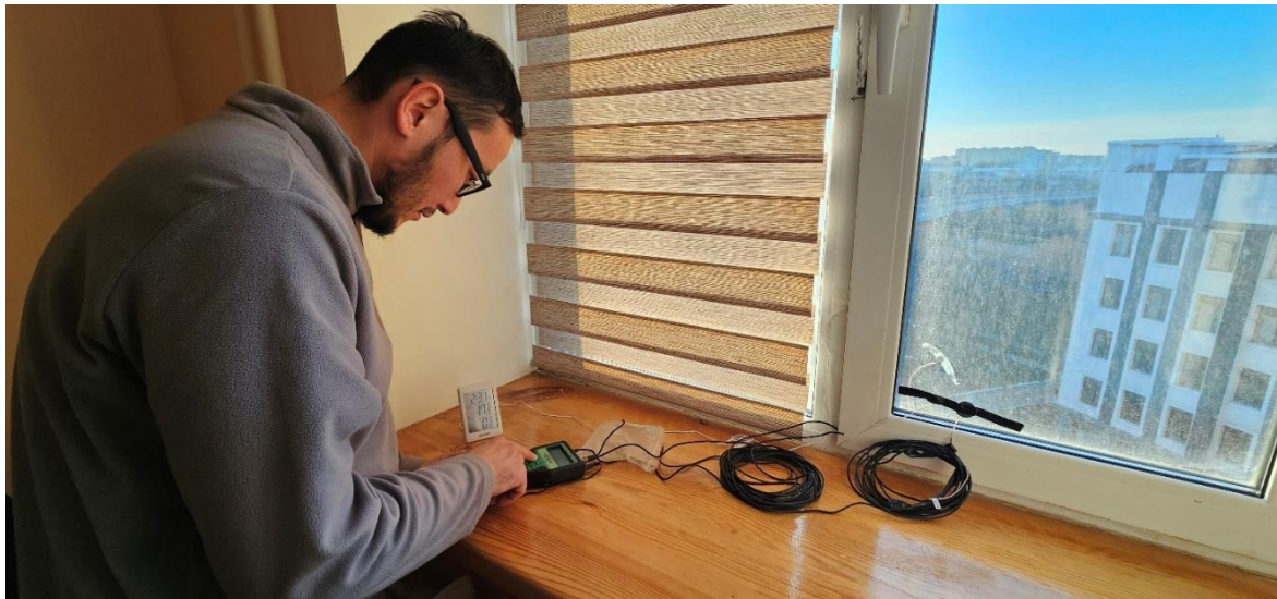
Определение фактического сопротивления теплопередаче наружной стены и оконного блока. © KazGBC
